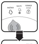
Insérez la plateforme en alignant la flèche pointant sur "Insérer" pour insérer la plateforme dans la base.
