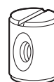
(F) Barrel Nut (x4) Écrou de barril (x4) Tuercas de barril (x4)
